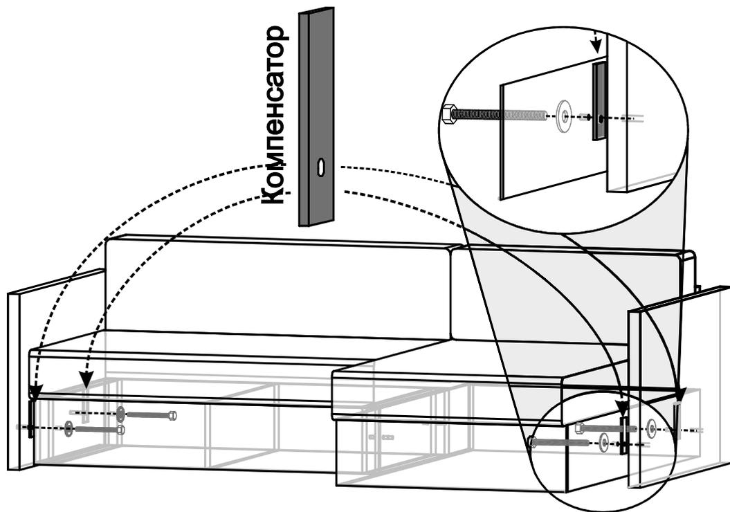
Компенсатор устанавливается в случае затруднительной работы выдвижного механизма (связанной с различной структурой и толщиной обивочных материалов используемых в изделии)
